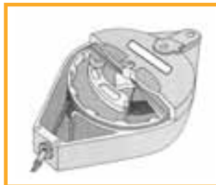
איור 69: מנגנון הפעלה בתוף תוף של בולם נפילה נסוג שבו משולב קפיץ מחזיר ובד"כ גם בולם זעזועים
