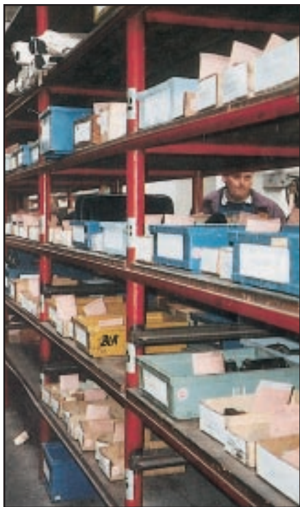
ניתן לאחסן פריטים קטנים ו/או חלקים עגולים וחלקים מתגלגלים, באריזות מישנה המונחת על המדפים
