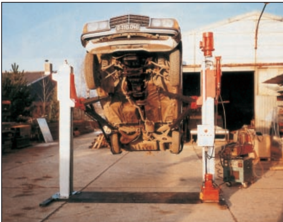
מגבה עם אפשרויות להטיית הרכב הוא פתרון ארגונומי, לשיפור תנוחת העבודה בתחתית הרכב
