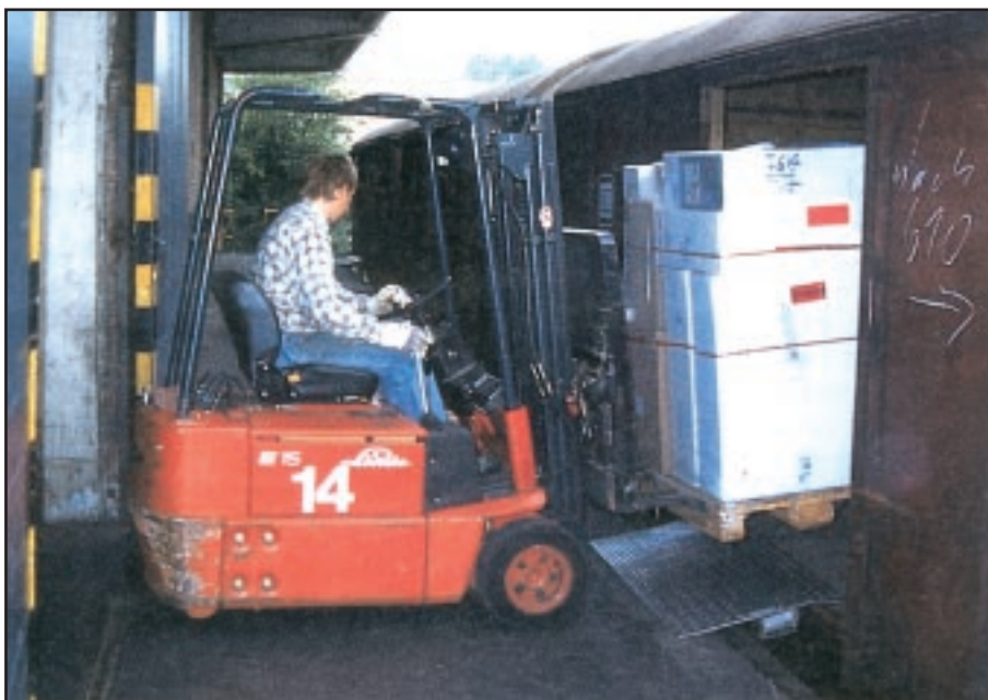
מלגזה עמוסה בכניסה לקרון משא. המזלגות נמוכים. המירווח בין מישטח ההעמסה וריצפת הקרון מחופה בלוח מקשר ייעודי
