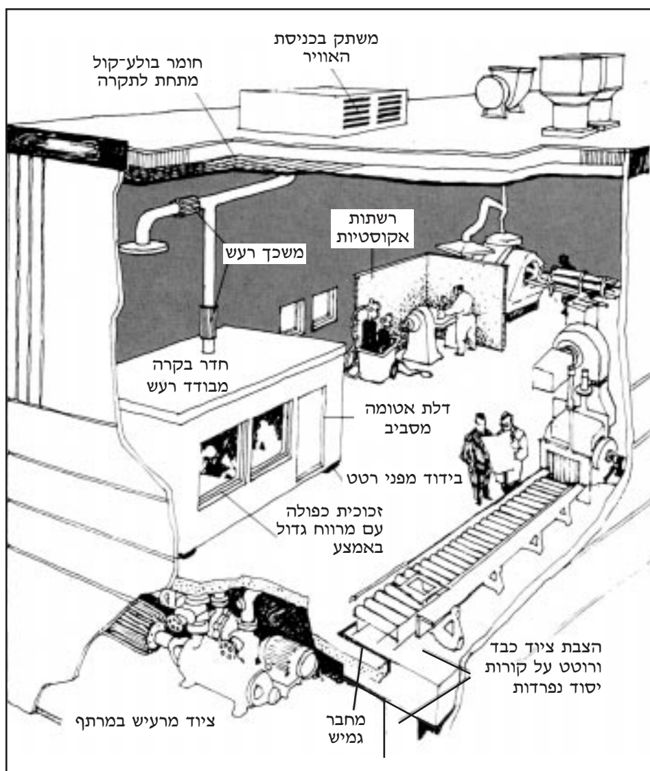
דוגמה לאמצעי בקרת רעש, שניתן ליישם בבניין תעשייתי כדי למנוע התפשטות רעש
