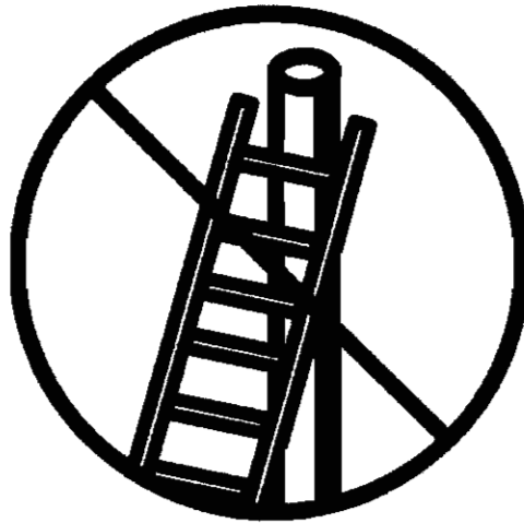
ציור א.16.2 – אין להשעין את הקצה העליון של הסולם באופן שאינו יציב
