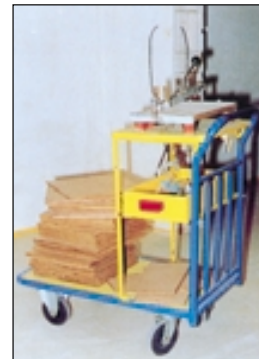
חיתוך מרצפות בעמידה על שולחן עבודה המורכב על גבי עגלת שינוע
