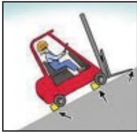
בעצירה על שטח משופע יש לאבטח את גלגלי המלגזה בפני הידרדרות
