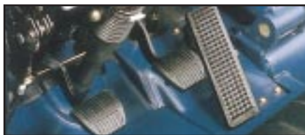
ודאו את קיומן ושלמותן של גומיות נגד החלקה על הדושות
