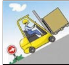
נסיעה עם מיטען על מישור משופע: בעלייה סעו תמיד קדימה. בירידה - יש לנסוע תמיד לאחור
