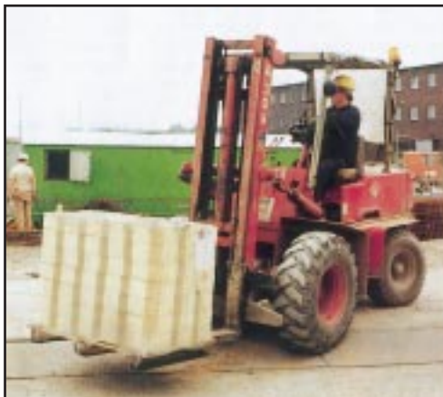
העברת מיטענים - רק על גבי מישטחים תקינים, מתאימים למיטען ומאובטחים
