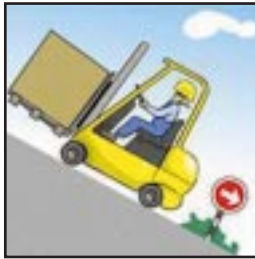
נסיעה עם מיטען על מישור משופע: בעלייה סעו תמיד קדימה. בירידה - יש לנסוע תמיד לאחור
