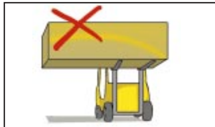
לא נכון ומסוכן! אין לשנע על המזלגות מיטענים שמרכז הכובד שלהם איננו מונח בקו מרכז הכובד של המלגזה
