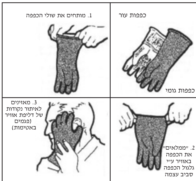
שלבי בדיקת אטימות של כפפות מגן המיועדות לעבודות חשמל
