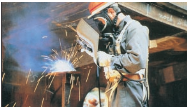
מסיכת מגן להגנת העיניים מפני קרינה אולטרה-סגולה בריתוך. הרתך מצויד במערכת אספקת אוויר, המונעת ממנו לנשום את האדים המזיקים
