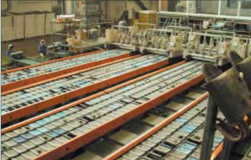
מיון האבוקדו לפי משקל הפרי וללא מגע יד אדם. האבוקדו מוטען לכפות, הנתונות במסלול שקילה ומשחררות את הפרי לתוך מסלולי אריזה, לפי משקל הפרי, ללא צורך בטיפול ידני. הפרי המוזן לתוך מסלולי האריזה משונע דרך מכונה להדבקת תוויות זיהוי מתאימות
