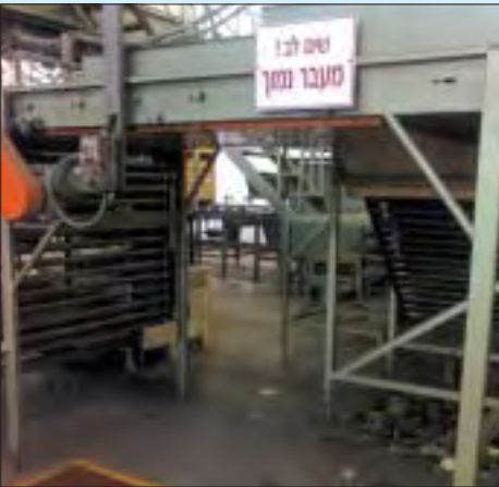
מעבר מתחת למסלולי השינוע של הפרי. המשקוף העליון של המעבר נמצא ברום של כ-170 ס"מ, ומעליו מערכות ההנעה של מסלול השינוע. כדי למנוע היתקלות הראש במעבר אדם בגובה ממוצע הותקן מיגון תחתי וגם שילוט מאיר עיניים, לאזהרה
