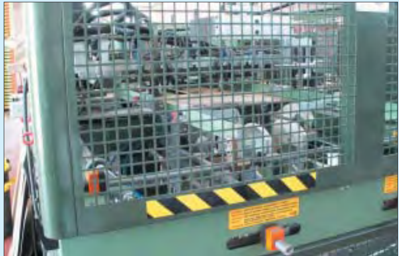
גידור סביב מכונות הקיפול האוטומטי של מגשי הקרטון לאריזה הפרי, למניעת נגישות מסוכנת אליהן
